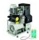
Aspiración progresiva, de 1 a 3 equipos en su versión A. Con su sistema inverter, reconoce en cada momento las necesidades de aspiración, adaptando la velocidad del motor en tiempo real. Con separador de amalgama ISO 18. Potencia rendida: 1.22 kW - 7 A. Caudal máximo: 1400 l/min (1700 l/min).
